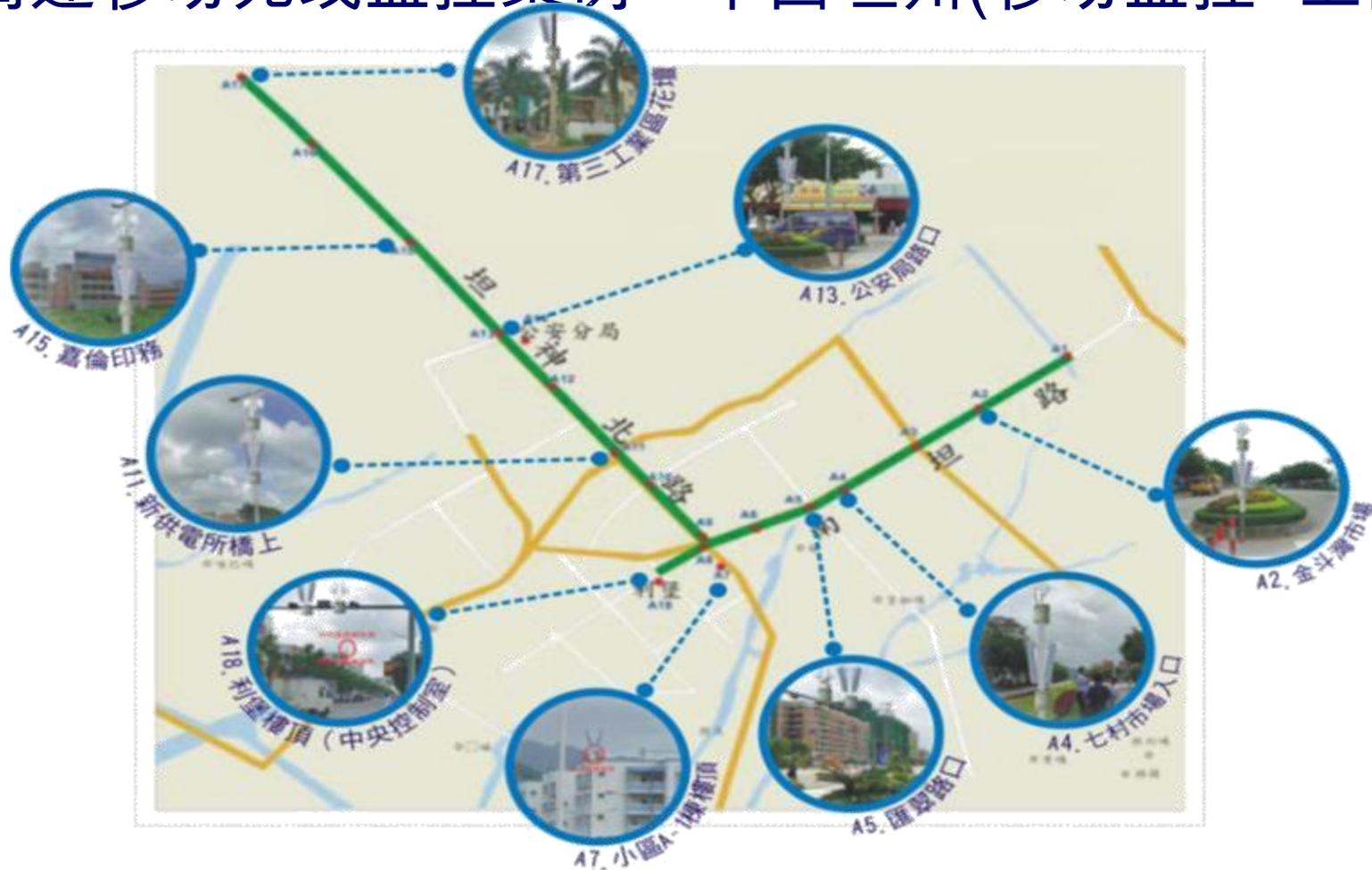
A1-A10 :双层架构, 距离5Km, 骨干2台+移动2台摄影机, 带宽10~12Mbps
