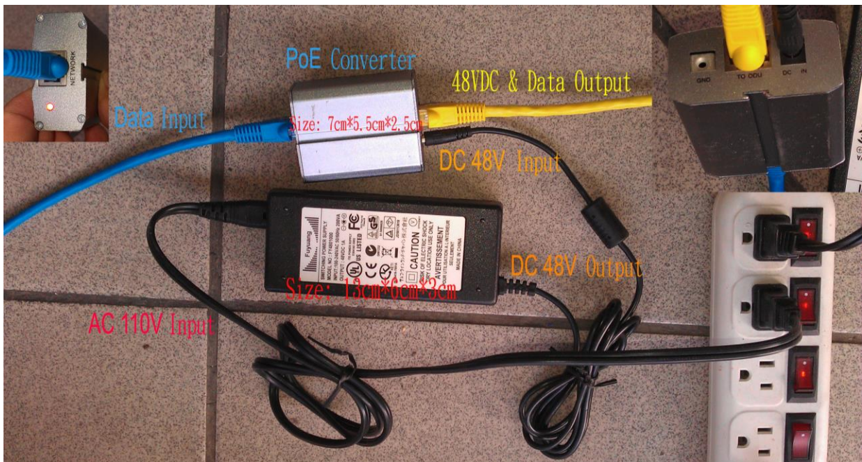
PoE 以太网供电整合器 RJ-45 以太网插孔, 连到无线设备 DC 电源插孔, 连接到变压器
