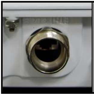
无线设备下方 PoE 以太网防水插孔
