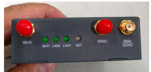
R200LW 系列:3G4G 主天线接头 Wi-Fi:WiFi 天线 SMA 接头 MIMO: 4G 的 MIMO 传输用天线
